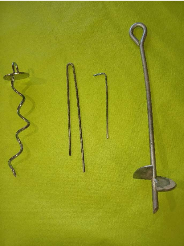
Kuva 15 Erilaisia kiinnityskiiloja rakenteille. Keskellä perusmallit ja reunoilla kierremallit.
