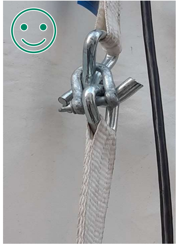
Kuva 8 HYVÄ TAPA. Koukut lukittu sakkellilla.
