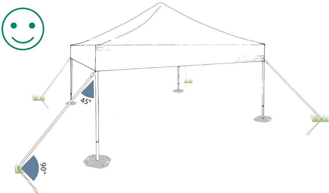
Kuva 16 MASTERTENT-teltan pystytyskuva, harusten, kiilojen sekä rakenteiden oikeasta kiinnitystavasta
