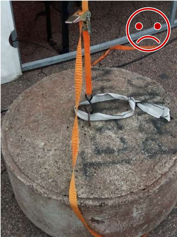
Kuva 7 EI NÄIN. S-koukku ei ole lukittava. Koukku irttaa rakenteen liikkeessa.
