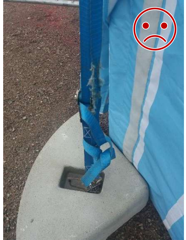
Kuva 10 Ei NÄIN. Kuormaliina on kulunut.
