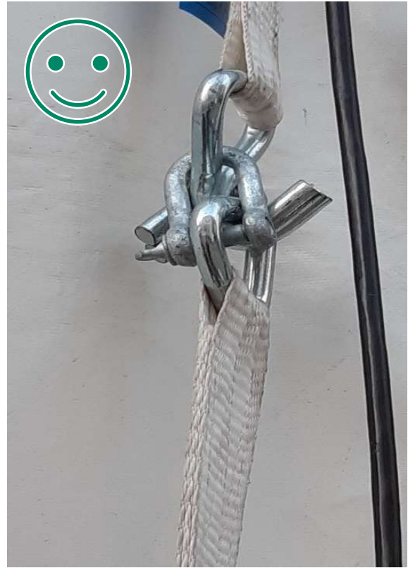
Kuva 8 HYVÄ TAPA. Koukut lukittu sakkellilla.
